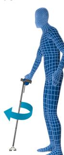
Mantenga la base firme en el suelo y gire la empuñadura una vuelta completa.
